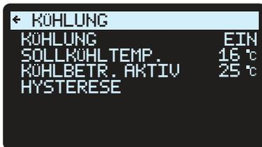
KÜHLUNG wird zur Aktivierung der Kühlung verwendet. **ERFORD.KÜHLTEMP** ist die erforderliche Temperatur für die Kühlung. **KÜHLBETR. AKTIV** gibt die niedrigste Außentemperatur an, bei der die Kühlung zulässig ist.
