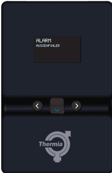
Prüfen Sie die Alarmanzeige regelmäßig, um sicherzustellen, dass die Installation korrekt funktioniert. Im Alarmfall wird die Wärmepumpe wenn möglich Wärme ins Haus liefern. Zuerst mit dem Kompressor, danach mit der Zusatzheizung. Die Warmwasserbereitung wird eingestellt, um anzuzeigen, dass etwas eingetreten ist, das beachtet werden muss.
